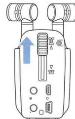
1. Schieben Sie den Mikrofonschieber auf der Geräterückseite nach oben, bis er einrastet.
