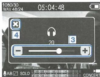
3. Tippen Sie auf und oder bedienen Sie den eingeblendeten Schieberegler, um die Lautstärke einzustellen.
